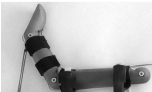
Рис. 1. Фізична модель трьохфалангового пальця кисті
